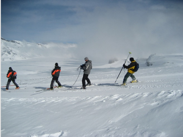
Figure 4 – Systèmes de mesures georadar héliportés ou au sol pour mesures nivologiques et glaciologiques
