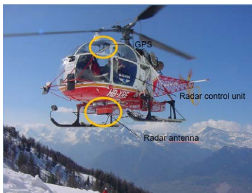
Figure 3 – Recherche de victime d'avalanche par georadar héliporté (image et scan georadar tirés d'un exercice de sauvetage en 2018)
