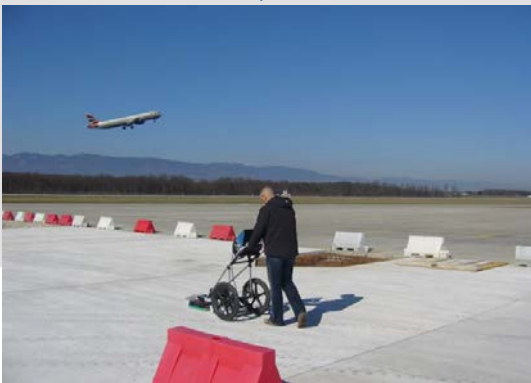
Cartographie des armatures sur le tarmac de l'aéroport de Genève-Cointrin
