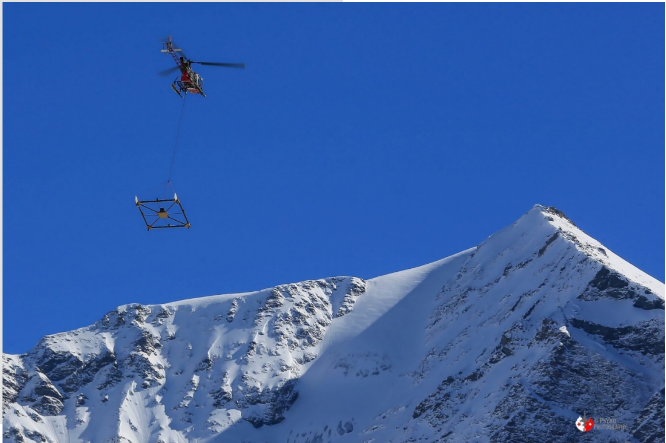
Figure 6 – Système GPR AIR ETH lors d’une campagne de mesures dans le Val d’Hérens
